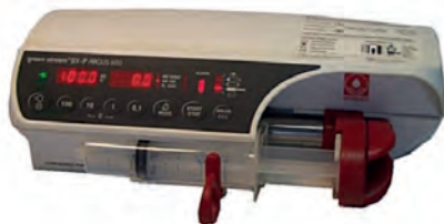
Lineární dávkovač – slouží k přesnému a bezpečnému dávkování léků a farmak
